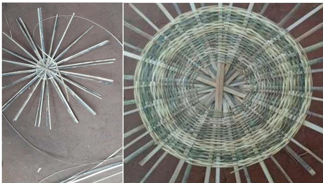
Figura 67: Entrelaçamento de uma mesa de bambu
