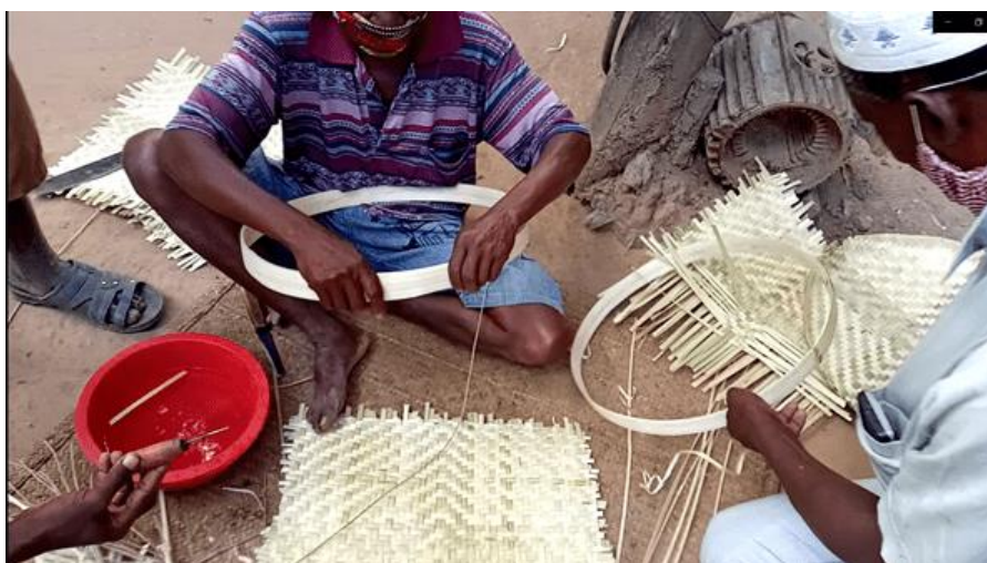
Figura 11: Artesãos colocando o contorno da peneira
