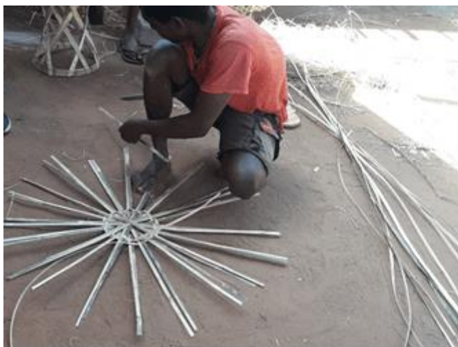
Figura 22: Disposição radial das tiras no entrelaçamento
