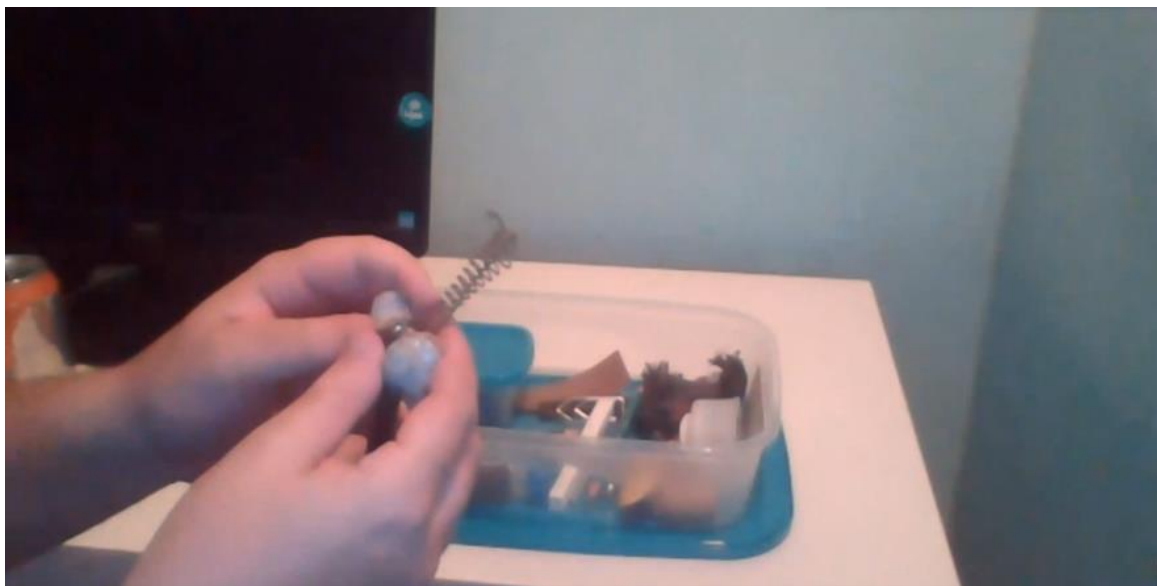
Figura 2 – Nesta imagem o estudante manipula o multímetro na escala de teste de condutividade a fim de verificar, em uma caixa cheia de objetos, quais seriam condutores e quais seriam isolantes. A imagem foi feita durante a aula.
