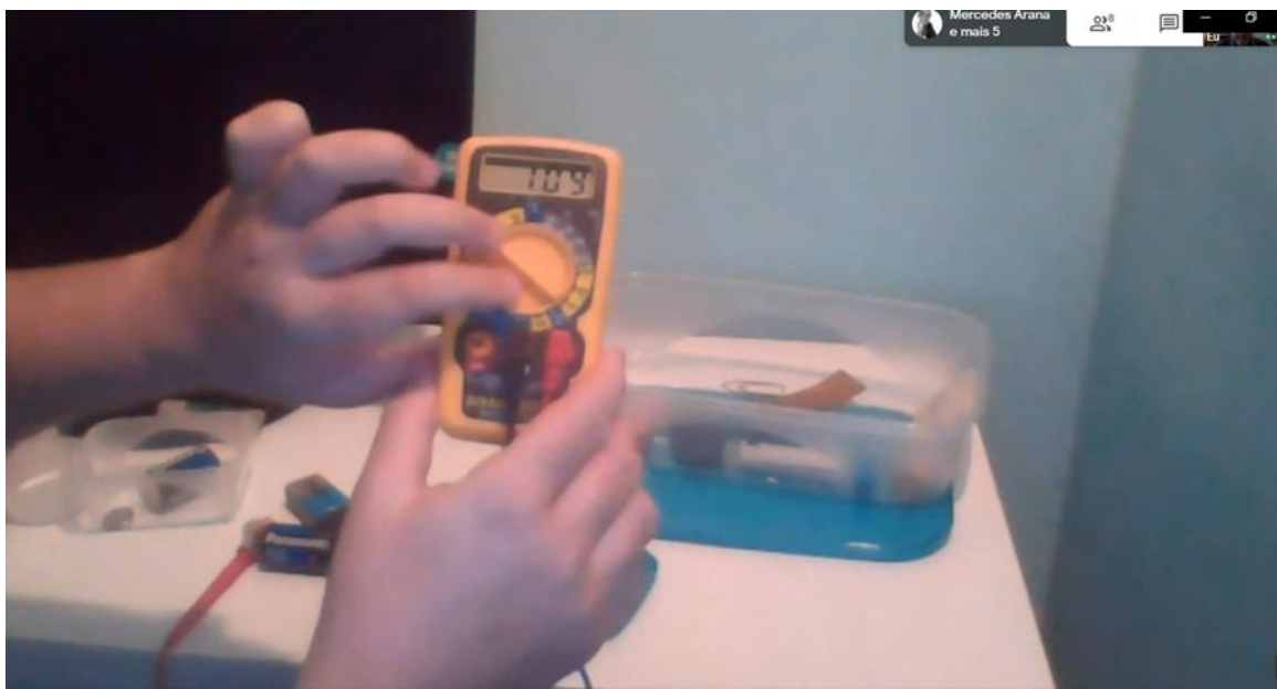
Figura 12 – Nesta imagem o estudante manipula, durante a aula, o multímetro na escala de voltímetro para medir a ddp de diversas pilhas e baterias.
